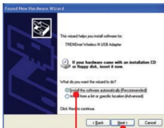
10. Выберите **Установить программное обеспечение автоматически** (**Install the software automatically**) (рекомендуется) и щелкните по кнопке **Next** (Далее).
