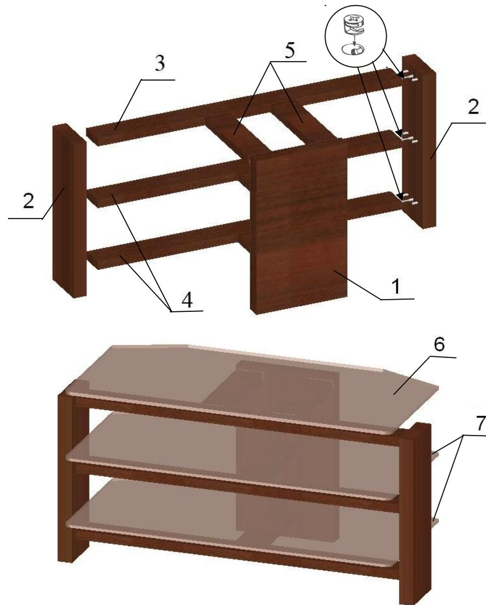
Рис.1 Схема сборки стойки
