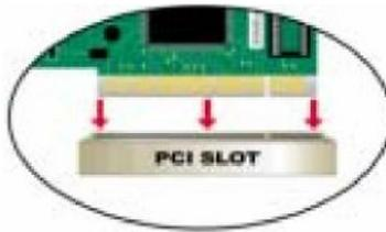
**Примечание:** Во избежание повреждения устройства статическим электричеством, пожалуйста, дотроньтесь до заземленного корпуса компьютера перед установкой или работой с DFE-520TX.
