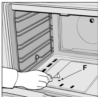
Если модель оснащена устройством безопасности, рукоятку **М** следует держать нажатой не менее 6 секунд (давая выход газу) для прогрева датчика устройства.
