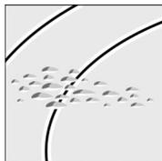
A következő sérülések nem befolyásolják sem a üvegkerámia működését sem a stabilitását.
