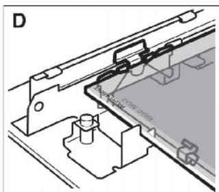
5. Отожмите наружу опорные пружины справа и слева, чтобы стекло прилегло (рис. D).
