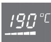
Дисплей отображает заданные значения. Индикатор контроля за нагревом, расположенный под индикатором температуры, показывает увеличение температуры или состояние остаточного тепла в духовом шкафу.
