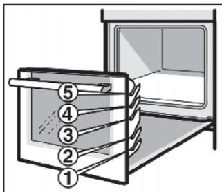
Принадлежности можно размещать в духовом шкафу на 5 различных уровнях при помощи крючков, расположенных слева и справа на выдвижной тележке духового шкафа.
