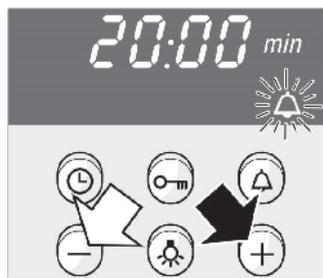
2. Установите время таймера с помощью кнопки + или кнопки -. На дисплее появляется предлагаемое значение времени таймера. При нажатии кнопки + предлагаемое значение = 10 минут. При нажатии кнопки - предлагаемое значение = 5 минут.
