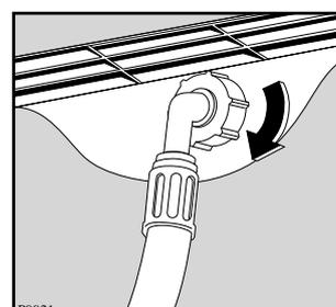
Другой конец наливного шланга, подключающийся к машине, может быть повернут в любом направлении. Ослабьте гайку, поверните шланг и вновь затяните гайку, проверив отсутствие течей воды. Наливной
