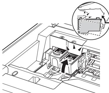
**7** Слегка поднимите модуль сканирования (крышку принтера), так чтобы упор модуля сканирования вернулся в исходное положение, а затем аккуратно закройте модуль сканирования (крышку принтера).
