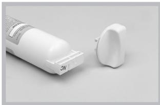
2. Снимите крышку, стянув ее с конца старого картриджа. Крышка снимается вправо или влево. **НЕ ВЫБРАСЫВАЙТЕ КРЫШКУ.**
