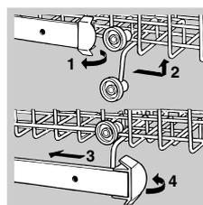
откройте крепления направляющих корзины справа и слева и выньте корзину. Установите ее сверху или внизу, пропустив ее по направляющим вплоть до входа передних роликов и закройте крепления (см. рисунок).
