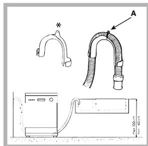
Специальная пластмассовая направляющая\* служит для оптимального размещения сливного шланга: прочно закрепите направляющую на стене во избежание смещения сливного шланга и утечки воды. Отрезок шланга, промаркированный буквой А, должен располагаться на высоте от 40 до 100 (см
