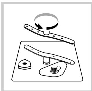
Остатки пищи могут прилипнуть к лопастям оросителя и засорить отверстия, из которых выходит вода: время от времени следует проверять оросители и прочищать их неметаллической щеткой.
