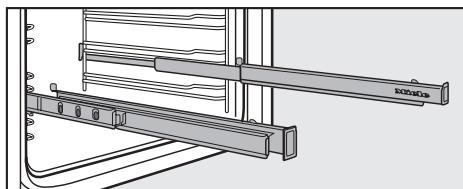
Телескопические направляющие FlexiClip можно закрепить на каждом ярусе загрузки и полностью выдвигать из рабочей камеры. Они обеспечивают оптимальный обзор приготовляемого блюда.
