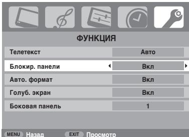
Если для функции **Блокир. панели** установлено значение **Вкл**, при нажатии кнопок на телевизоре отобразится напоминание об этом. Если будет нажата кнопка режима **ожидания**, телевизор выключится, и включить его можно будет только с помощью пульта дистанционного управления.
