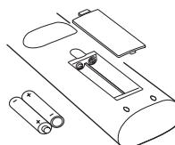
Снимите заднюю крышку, открываяющую доступ к батарейному отсеку, и вставьте батарейки, соблюдая полярность. Для данного пульта дистанционного управления подходят батарейки типа AAA, IEC R03 1,5 В.
