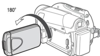
Объект съемки может контролировать изображение на экране ЖК-дисплея.
