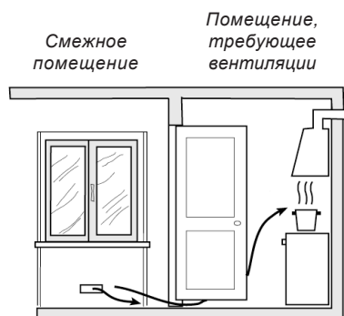
3 Обеспечение необходимого зазора между дверью помещения и порогом для свободного прохода приточного воздуха
