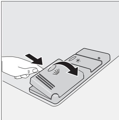
2. Заполните дозатор моющего средства (1) моющим средством. Маркировка указывает на уровни дозировки:
