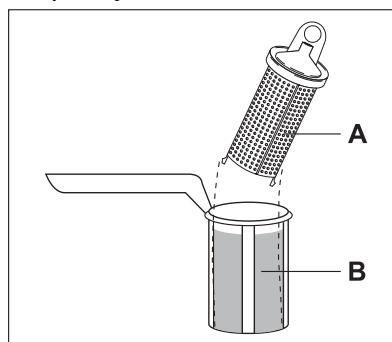
3. Поверните ручку против часовой стрелки примерно на 1/4 оборота и снимите фильтрующую систему.
