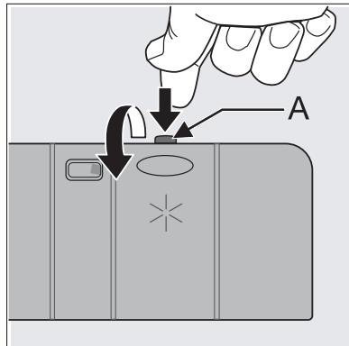
2. Залейте ополаскиватель в емкость. Максимальный уровень заполнения соответствует отметке "max".
