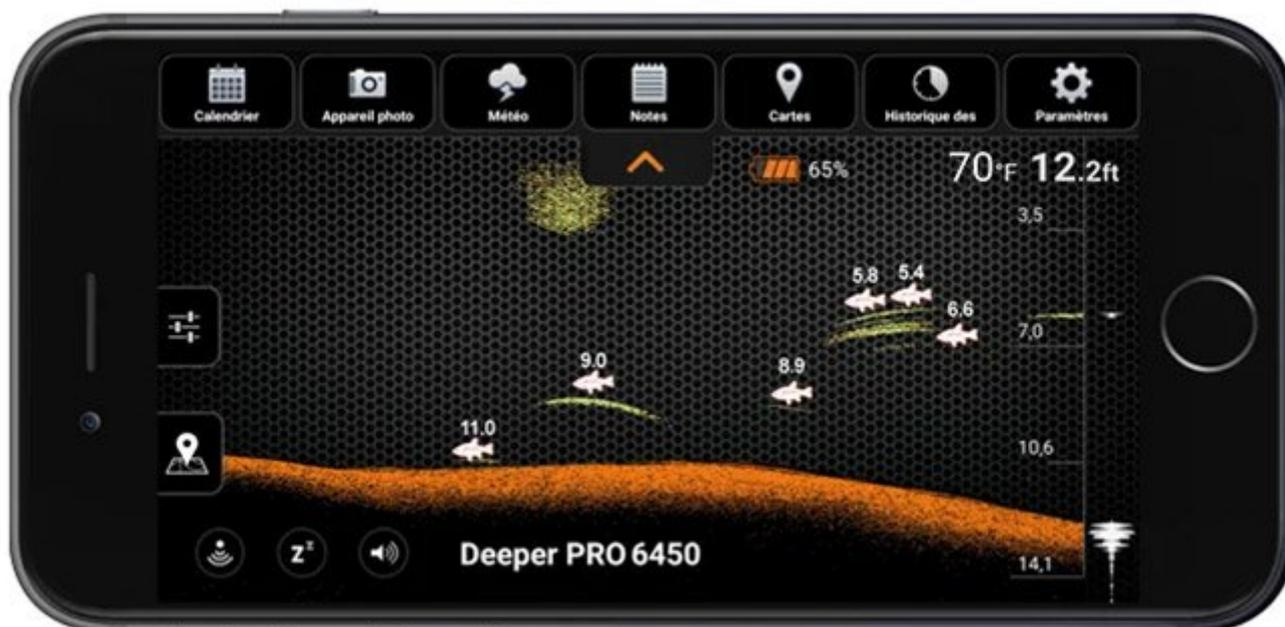
**Дно**: Деерег может помочь вам определить, является ли дно твердым или мягким. Когда звуковые волны сонара отражаются от дна, жесткое дно возвращает более сильный сигнал, чем мягкое дно. Определить
