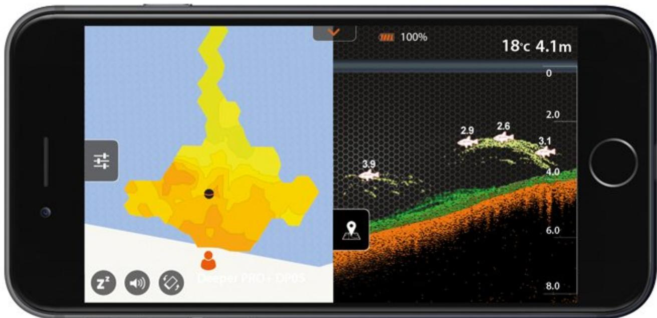
У эхолотов Deeper PRO+ и CHIRP+ есть GPS-приемник, который позволяет создавать батиметрические карты путем заброса и проводки эхолота. Береговой режим GPS работает так же, как и в режим Лодки. Но вместо использования GPS смартфона, используется встроенный GPS-приемник, установленный в Deeper PRO +.
