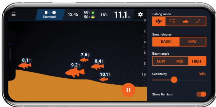
**Ширина угла луча** — выбор угла сканирующего луча вашего эхолота Deeper. **Этой настройке нет в модели Deeper START**
