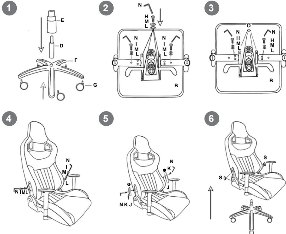
Для предотвращения возможного скрипа, мы рекомендуем Вам зафиксировать пластиковые кольца **O** между сидением **B** и механизмом **C**, закрепив болтами
