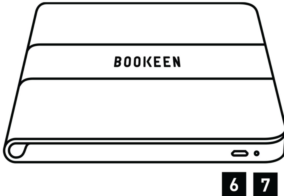
[6] Разъем MicroUSB: он позволяет вам подключить ваше устройство Bookeen Saga к компьютеру или зарядному устройству с USB-разъемом (в комплект не входит) при помощи USB-кабеля.
