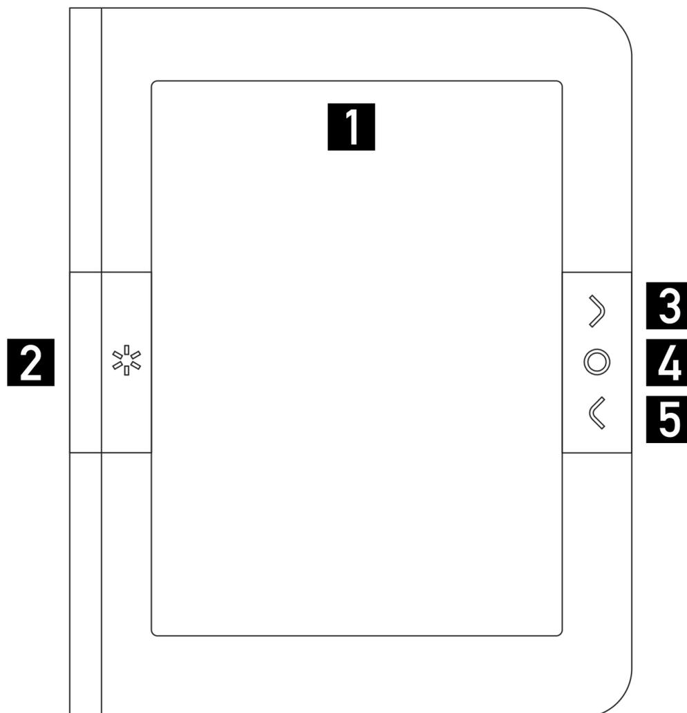
[1] Сенсорный дисплей E Ink®, поддерживающий: касание, многоточечное касание («мультитач»), прокрутку, панорамирование, пролистывание, масштабирование, поворот, зеркальное отражение и др. Дисплей реагирует на простое касание пальцем.
