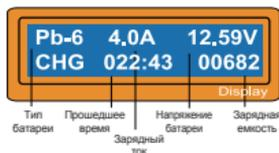
На экране отображается состояние процесса зарядки. Чтобы остановить зарядку принудительно, нажмите один раз кнопку Batt / Stop. Звуковой сигнал указывает на то, что вы в конце процесса.
