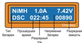
Установите разрядный ток слева и конечное напряжение справа. Разрядный ток находится в диапазоне от 0,1 до 2,0 А, а конечное напряжение составляет от 0,1 до 16,0 В). Чтобы начать процесс, зажмите клавишу «Пуск / Ввод» более 3 секунд.
