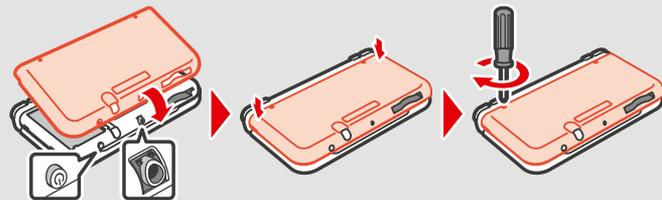
Отверстия в крышке батареи должны находиться над кнопкой POWER и разъемом для аудио на нижней части системы.
