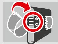
**1** Ослабьте винты на крышке отсека аккумуляторной батареи (задней крышке)
