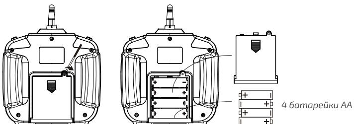
При помощи отвертки выкрутите фиксирующий винт и снимите крышку батарейного отсека. Строго соблюдая полярность, как показано на рисунке, установите в отсек 4 батарейки АА, затем закройте крышку и закрутите фиксирующий винт.
