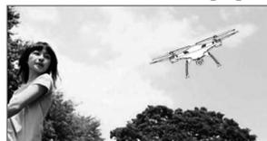
Данный квадрокоптер оснащен 6-и осевой системой стабилизации с встроенным гироскопом, и это значительно облегчает управление. После выполнения маневра вы можете просто отпустить ручку передатчика в центральное положение, и квадрокоптер автоматически зависнет на месте в стабильном положении.
