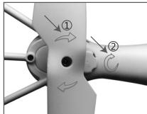
При установке пропеллеров убедитесь, что направление стрелки 1, изображенной на пропеллере соответствует направлению стрелки 2 (см. рисунок), которая изображена на личе квадрокоптера.
