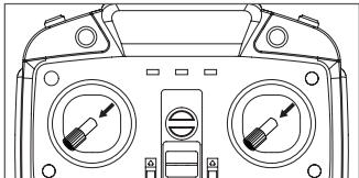
После инициализации связи установите модель на ровную горизонтальную поверхность, затем одновременно переместите обе ручки управления на передатчике в нижний левый угол и держите их в этом положении в течение 2x-3x секунд. Индикатор на борту квадрокоптера начнет быстро мигать, и, приблизительно через 5 секунд, вернется в нормальное состояние.
