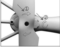
При установке пропеллеров убедитесь, что направление стрелки 1, изображенной на пропеллере соответствует направлению стрелки 2 (см. рисунок), которая изображена на луче квадрокоптера.
