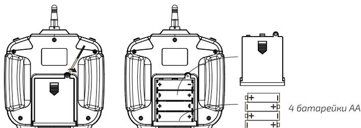
При помощи отвертки выкрутите фиксирующий винт и снимите крышку батарейного отсека. Строго соблюдая полярность, как показано на рисунке, установите в отсек 4 батарейки AA, затем закройте крышку и закрутите фиксирующий винт.
