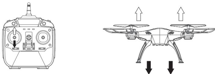
При перемещении левой ручки передатчика от себя модель набирает высоту, при перемещении этой ручки передатчика на себя – модель снижается.
