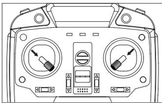
При перемещении ручки газа передатчика в крайнее нижнее положение моторы модели не могут мгновенно остановиться. Чтобы быстро выключить двигатели одновременно переместите левую ручку в правый нижний угол, а правую ручку в левый нижний угол (как показано на рисунке), и удерживайте их так в течение одной секунды — моторы немедленно выключатся.
