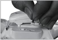
2. Как показано на рисунке, вставьте разъем камеры в гнездо питания камеры, которое расположено в нижней части корпуса модели.
