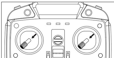
После инициализации связи установите модель на ровную горизонтальную поверхность, затем одновременно переместите обе ручки управления на передатчике в нижний левый угол и удерживайте их в этом положении в течение 2х-3х секунд. Индикатор на борту квадрокоптера начнет быстро мигать, и, приблизительно через 5 секунд, вернется в нормальное состояние.
