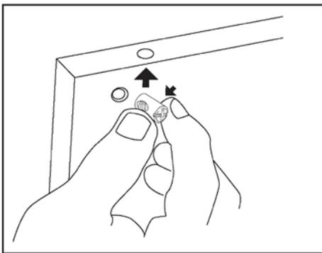
*Обязательно убедитесь в том, что болт проходит через отверстие стойки перпендикулярно ее поверхности и попадает в отверстие цилиндрической гайки. Чтобы избежать смещения резьбы, при завинчивании используйте две отвертки: одну для удерживания в нужном положении цилиндрической гайки, а другую для завинчивания винта в гайку.*
