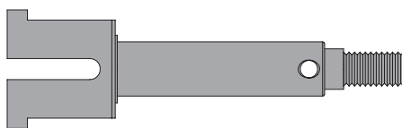
86249 a Усиленный вал 8x11x59mm
