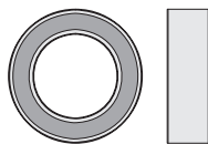
B032 Шарикоподшипник 10x16x5mm
