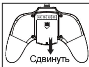
**2.** Нажмите слегка на центр и сдвиньте вниз крышку батарейного отсека.
