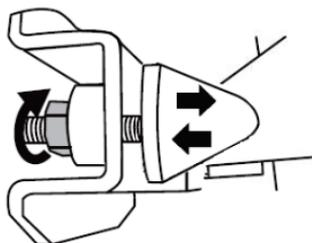
**Примечание:** если конусообразный стопор расположен слишком близко к задней части рычага педали, могут возникнуть проблемы с достижением максимального значения калибровки. В этом случае:
