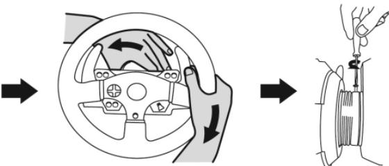
Установив руль, поверните его на 180° (если смотреть на руль, логотип Thrustmaster должен быть перевернут «вверх ногами»), чтобы получить доступ к малому крепежному винту на кольце системы Thrustmaster Quick Release. С помощью большой отвертки Phillips затяните малый крепежный винт (без чрезмерного усилия) по часовой стрелке.
