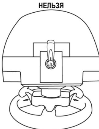
**ВНИМАНИЕ!** Нельзя закручивать винт без системы крепления!
