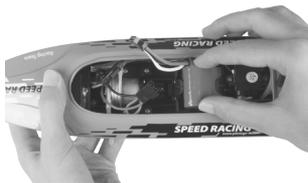
02. Установите Li-ion батарею в аккумуляторный отсек внутри корпуса.
