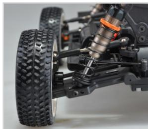
Конструкция амортизатора предусматривает возможность установки пружин различной жесткости. Пружины обеспечивают различную жесткость подвески и изменяют характеристики управляемости модели. Если задние амортизаторы будут оборудованы жесткими пружинами, модель станет более управляемой, но несколько снизится сцепление задних колес на некоторых режимах движения. Если более жесткие пружины поставить на передние амортизаторы - управление будет менее отзывчивым.
