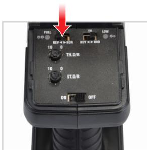
Если перемещение колес не соответствует выше описанному направлению, переключите реверс рулевого управления на передатчике. Поверните рулевое колесо передатчика до упора влево (или вправо), затем нажмите и удерживайте две секунды кнопку "REV" чтобы реверсировать канал.
