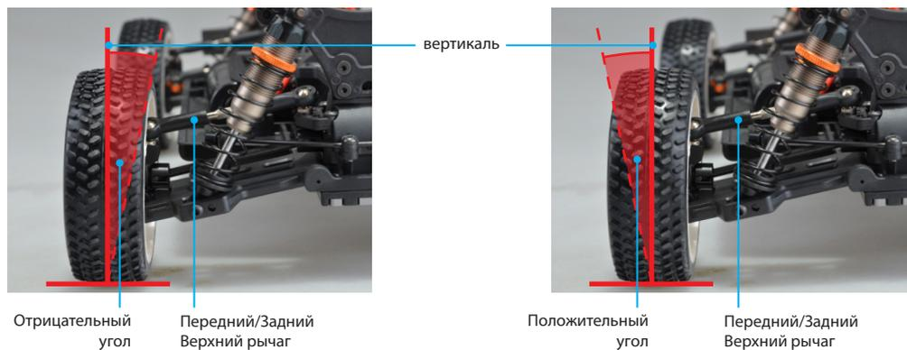
Отрицательный развал колес - это когда верхние части колес расположены ближе к центру модели, чем нижние. Отрицательный развал обеспечивает больший контакт колес с поверхностью в повороте. Большой отрицательный развал уменьшает сцепление колес с поверхностью и приводит к износу внутренней стороны протектора.
