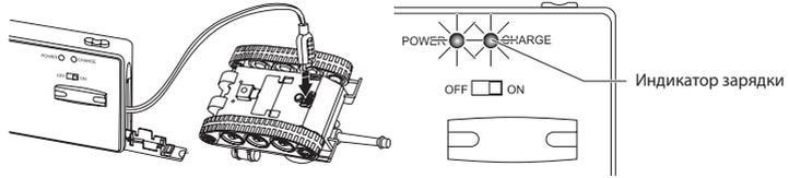
2. Когда аккумулятор полностью зарядится (приблизительно через 10 минут), индикатор зарядки погаснет. С полностью заряженным аккумулятором танк работает около 5 минут.
