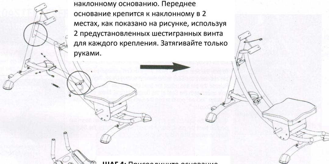
**ШАГ 4:** Присоедините основание для рук к передней штанге, используя 4 предустановленных шестигранных винта. Затяните все болты и винты с помощью инструментов. Наденьте на болты защитные черные пластиковые колпачки.
