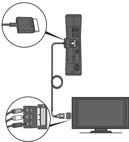
Подключите композитный AV-кабель к телевизору.
