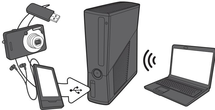
Систему Xbox 360 можно использовать для воспроизведения музыки, просмотра изображений и видеороликов с других устройств. К ней можно подключать различные устройства, портативные аудиопроигрыватели, цифровые камеры и флэш-накопители USB. Кроме того, можно использовать в консоли медиаданные с компьютера с Windows, подключенного к той же домашней сети.
