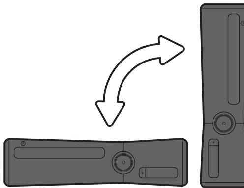
Консоль можно установить горизонтально или вертикально. Прежде чем менять ориентацию консоли, убедитесь в том, что она отключена и в лотке дисковода отсутствует диск. Независимо от того, как располагается консоль, проверьте, не закрыты ли вентиляционные отверстия или ИК-приемник.
