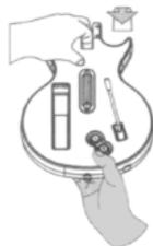
3. Совместите выступы новой панели с отверстиями на корпусе контроллера. Проверьте, что рычаг снятия панели находится в положении «открыто». Нажмите на панель для окончательной ее установки. Передвиньте рычаг снятия панели в положение «закрыто».
