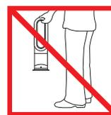
Не переносите устройство, держа его за усилитель воздушного контура. Усилитель воздушного контура не является ручкой для переноса.
