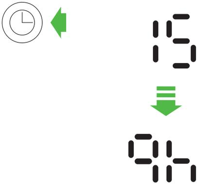
Чтобы установить таймер сна, нажмите и удерживайте кнопку таймера для выбора нужного времени. По истечении времени устройство перейдет в режим ожидания. Для отмены уменьшайте значение времени до появления двух тире.
