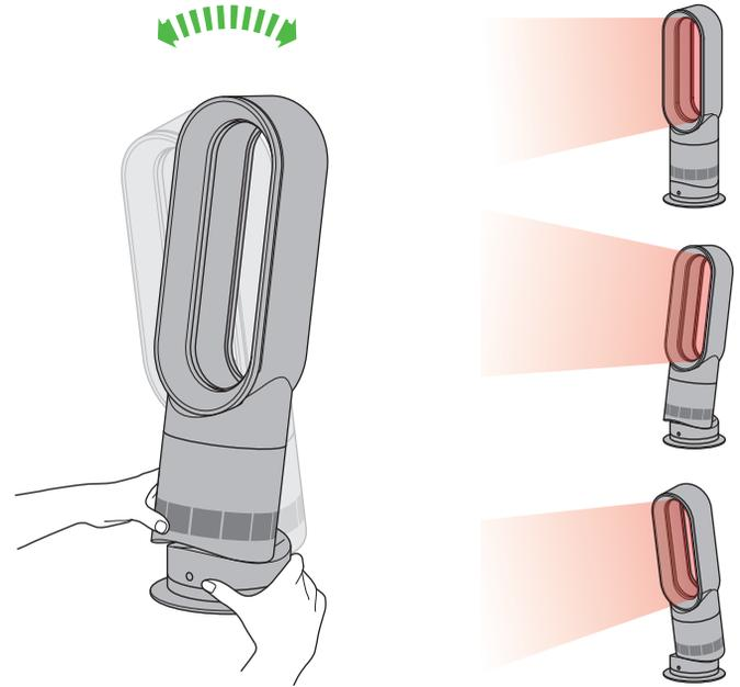
Осторожно возьмитесь за основание и за основную часть корпуса. Наклоните усилитель вперед или назад для достижения необходимого угла воздушного потока.
