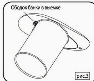
ПРИМЕЧАНИЕ: Нож не будет работать, если ободок крышки не вошел в выемку нижней части прибора.
