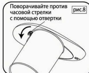
**ПРИМЕЧАНИЕ:** После помещения батареек на место, продолжайте крутить винт разблокировки, одновременно нажимая и удерживая переключатель заднего хода и защитный выключатель, пока нож не займет прежнее положение. Не прикасайтесь к ножу во избежании получения травм.
