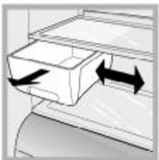
**КОНТЕЙНЕР МНОГОЦЕЛЕВОГО ИСПОЛЬЗОВАНИЯ\***: служит для хранения продуктов (например, холодной мясной нарезки) продолжительное время, также предотвращает распространение запахов в холодильнике. Контейнер можно снять с полки и для оптимизации места сдвинуть в сторону (см. рис.).
