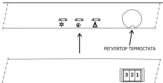
Термостат автоматически регулирует температуру в обоих отделениях. Устанавливая регулятор термостата между отметками "1" и "5", можно изменять температуру в холодильнике.
