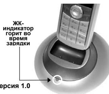
Во время зарядки индикатор зарядки базового блока будет гореть. В то же время, на дисплее трубки, внутри иконки батареи, будут перемещаться справа налево специальные полоски. Когда батарея полностью зарядится, движение этих полосок остановится.
