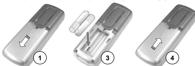
1. Сдвиньте крышку отсека батареи вниз в направлении стрелки и снимите крышку.
