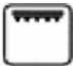
**ТОЛЬКО ЭЛЕМЕНТ ГРИЛЯ:** При этом методе запекания используется верхний элемент, который направляет тепло вниз на продукты питания. Эта функция подходит для обжаривания небольших порций бекона, тостов или мяса, и т.д.
