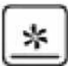
**ЗАПЕКАНИЕ ГОРЯЧИМ ВОЗДУХОМ И НИЖНИЙ НАГРЕВАТЕЛЬНЫЙ ЭЛЕМЕНТ:** Этот метод применяет нижний нагревательный элемент и вентилятор, который способствует циркуляции тепла. Эта функция пригодна для стерилизации и консервирования.
