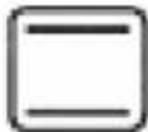
**ОБЫЧНАЯ ДУХОВКА (верхний и нижний элементы):** Этот метод приготовления соответствует традиционному запеканию, когда подогрев идет от нагревательных элементов снизу и сверху. Эта функция подходит для запекания только на одной решетке.
