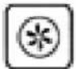
**ДУХОВКА С ГОРЯЧИМ ВОЗДУХОМ:** В этом методе используется круговой элемент, а тепло распределяется вентилятором. Речь идет о быстром и экономном методе приготовления. Горячий воздух позволяет одновременно печь на разных решетках и не позволяет запахам и вкусам блюд смешиваться.
