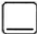
**ТОЛЬКО НИЖНИЙ ЭЛЕМЕНТ:** При этом методе запекания используется нижний элемент, который направляет тепло вниз на продукты питания. Для медленной жарки или подогрева продуктов.
