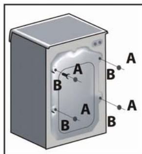
**Примечание.** Рекомендуем сохранить элементы транспортного крепления, чтобы использовать их в случае возможной будущей транспортировки. Производитель не несет ответственности за любые возможные повреждения машины по причине невыполнения правил, касающихся транспортного крепежа. Установка изделия производится за счет владельца машины.
