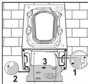
Внимание! При установке машины на ковровых покрытиях убедитесь, что вентиляционные отверстия гофрированного листа не закрыты ворсом.
