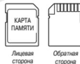
Расположив карту памяти лицевой стороной вверх (в направлении той стороны камеры, где находится экран монитора), вставьте карту до упора в карточный слот и нажимайте на нее до тех пор, пока карта с отчетливым щелчком не зафиксируется надежно на месте.
