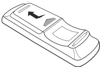
2. Вставьте в гнездо две батарейки, как показано на схеме, расположенной в отсеке.
