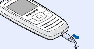
**Примечание.** Перед извлечением аккумулятора необходимо обязательно отсоединить зарядное устройство. В противном случае можно повредить телефон.
