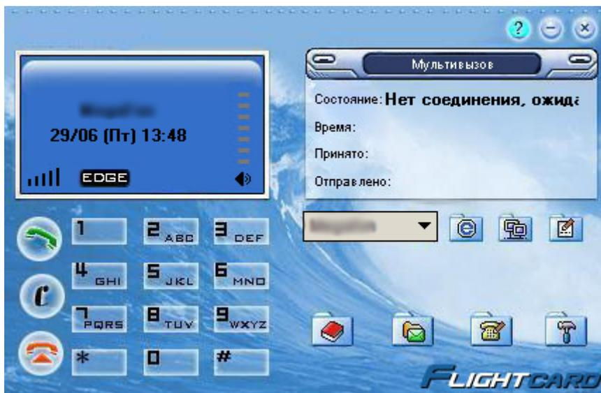
В главном окне программы располагается индикатор информации мобильного оператора, индикатор мощности сигнала, индикатор сети EDGE/GPRS, регулятор громкости гарнитуры, информация о соединении, элементы управления программой.
