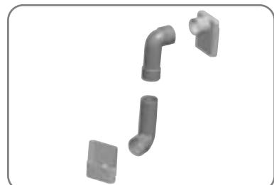
Для сборки соединить все части, соединяя пазы одной детали с соответствующими отверстиями другой.
