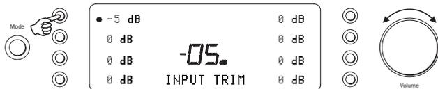
Для настройки ограничения усиления для входа каждого источника выберите команду 'INP TRIM' в меню конфигурирования системы. Выберите нужный вход и используйте регулятор громкости для настройки усиления между 0 и -12 дБ (доступный диапазон ограничен, если выбрано малое значение громкости). Для выхода нажмите кнопку режима (Mode).
