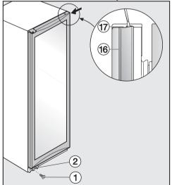
■ Вверните шуруп ① во внешнее отверстие уголка ②, чтобы закрепить ось подшипника в уголке.
