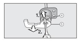
на рисунке, перед собой и выдавите вверх предохранительную шайбу 4 с помощью отвертки с плоской головкой.
