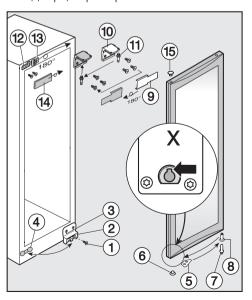
■ Выверните шуруп ① из нижнего уголка подшипника ②.
