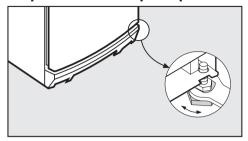
■ Выровняйте положение прибора, поворачивая его ножки с помощью прилагаемого гаечного ключа.
