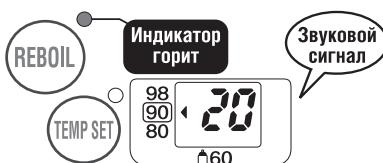
**✓** Жидкокристаллический дисплей отображает температуру с точностью до 5°C.
