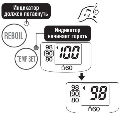
После того, как вода вскипела, произведет мелодия, индикатор кипения погаснет, а индикатор сохранения тепла начнет мигать. Когда температура воды опустится до 80 или 60°C, в зависимости от установленного режима, индикатор сохранения тепла перейдет в режим постоянного свечения, а на жидкокристаллическом дисплее отобразится число «80» или «60».
