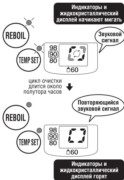
После цикла очистки (он занимает около полутора часов, о его окончании просигнализируют загоревшиеся постоянным светом индикаторы кипячения, сохранения тепла и переставший мигать жидкокристаллический дисплей) отсоедините термопот от электрической сети минимум на 5 секунд и вылейте горячую воду. Чтобы избавиться от запаха лимонной кислоты или средства для удаления накипи, наполните термопот водой, вскипятите и вылейте ее.
