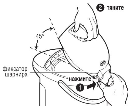
Чтобы вернуть крышку на место, вставьте ее в шарнир под углом порядка 45° с небольшим усилием. Посадка крышки в шарнир сопровождается легким щелчком.
