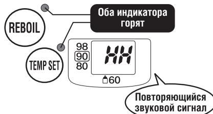
Для отключения защиты устраните причину ее срабатывания (заполните внутренний контейнер холодной водой) и нажмите на кнопку повторного кипячения REBOIL.
