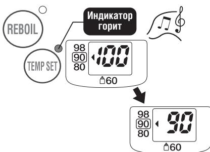
✓ Чтобы вскипятить полную емкость воды (4 л) необходимо порядка 45 минут при начальной температуре жидкости 20°C и такой же температуре окружающего воздуха. Время дехлорирования (около 4 минут) включено в общее время кипячения воды.
