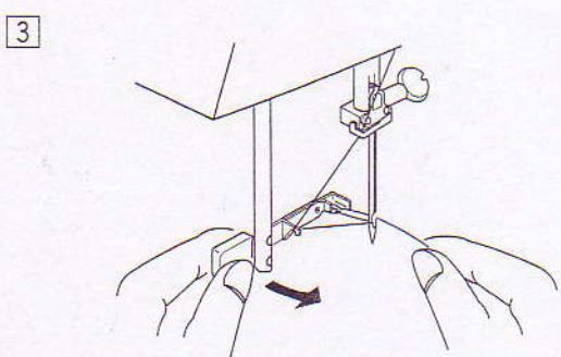
3 Потяните на себя рычаг нитевдевателя ①, чтобы вытянуть игольную нить, как показано на рисунке. Затем подтолкните рычаг нитевдевателя вверх и вытяните нить как показано на рисунке.
